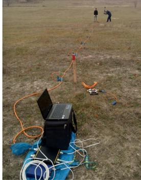
Рисунок 3 - Работа сейсморазведочной станции «Лакколит - 24X» в полевых условиях [3]
