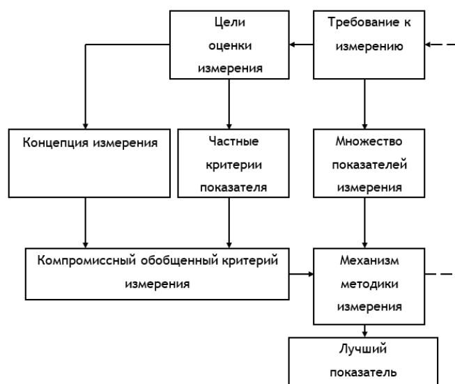
Рис. 1. Структурно-логическая схема для измерения ПДК вредных веществ в химической безопасности предприятия
